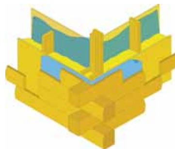
Typowy układ warstw ściany budynku mieszkalnego z bali izolowanych
